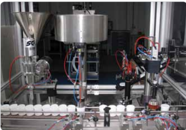
Obr. 4 Stroj plnička – celkový pohľad, detailný pohľad na manipulátor slúžiaci na zakladanie viek.
