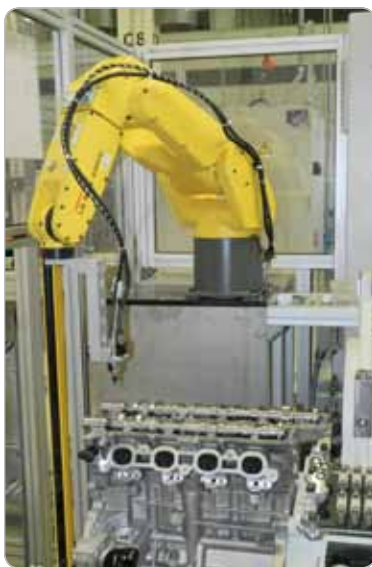
Obr. 1 Robot FANUC LR Mate 200iC pri nanášaní oleja na vačkový hriadeľ
